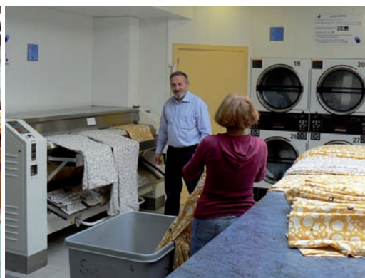
De g. à d. : la chaufferie est dimensionnée pour pouvoir chauffer un volume d'eau important en période de pointe (700 cycles/jour). 3 calandres permettent de repasser sur place le linge lavé. Les machines à laver de 24 kg et les séchoirs correspondants enregistrent un grand succès.
